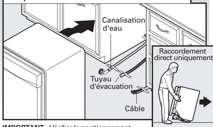
**IMPORTANT :** Vérifier le positionnement correct des éléments de raccordement (tuyau d'évacuation, conduit d'eau, câble électrique). Saisir les deux côtés du lave-vaisselle par les bords du panneau de porte. Incliner le lave-vaisselle vers l'arrière (en appui sur les roues) et rapprocher le lave-vaisselle de l'ouverture.
